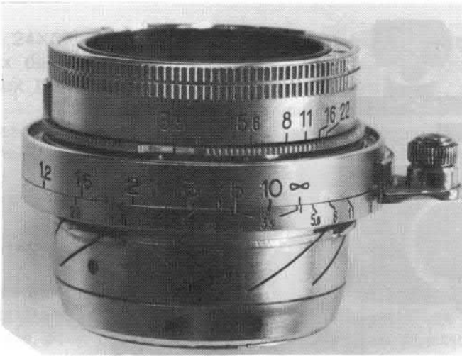
Grande lentille frontale, optique recalculée, ultra-chromatique dans l'infra-rouge à partir de 72800. Construction sur laiton diaphragmes crantés, embase chromé mat. Iris gravé à droite.
