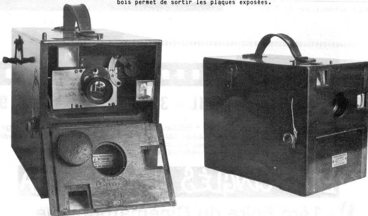
L'obturateur a guillotine ne découvre pas à l'armement et s'arme par tirage d'un cordon. Il dispose de trois vitesses par tension d'un ressort. D'après les trous de vis, l'obturateur d'origine a été modifié ou même changé. Peut-être le mécanisme à trois vitesses a-t-il été ajouté après ? (voir le No. 51 à une seule vitesse.)
