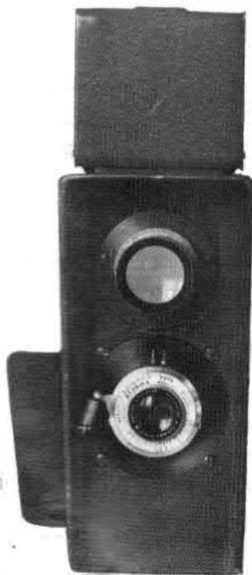
Sur le côté droit se trouvent: à l'arrière, un gros bouton pour l'entraînement de la pellicule avec un levier de blocage et à l'avant le levier du déclenchement de l'obturateur non couplé à l'avance du film.
