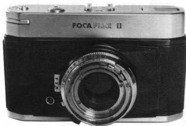
FOCAFLEX II 1961 Objectif retiré. On aperçoit les cinq pales de l'obturateur.
