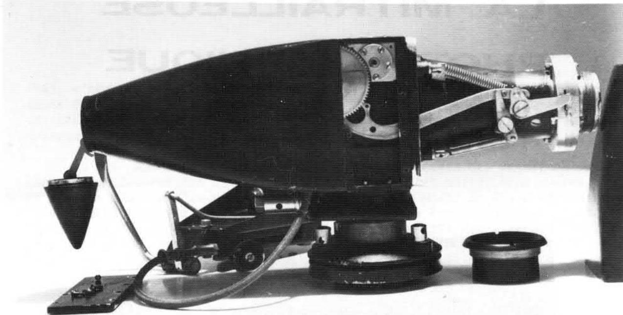
Côté droit. Le capot ouvert et la paroi droite ont été retirés. Le cône arrière est écarté en position de visée.
