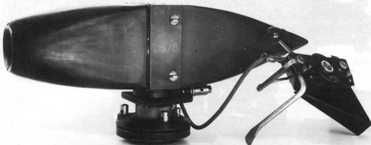
Vue du côté gauche de la mitrailleuse avec son poste de commande à distance. On distingue la porte du magasin au centre fermée par deux loquets. Caractéristiques: longueur 49 cm. hauteur 20 cm. poids 5 kgs. objectif PRECIOPTIQUE-LEVALLOIS F/5, focale 17 cm. Une seule vitesse d'obturation, pas de mise au point. Le compteur de vues gradué jusqu'à 15 est situé sur le poste de commande.
