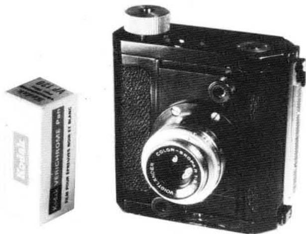
L'appareil utilise des optiques prévues pour le film 35 m/m, ce qui permet toutefois de couvrir entièrement la hauteur d'une bobine de 120, étant donné que la prise de vue se fait à travers une fente qui se règle entre 0,5 et 4 m/m, quand les conditions de lumière rendent cette variation nécessaire.
