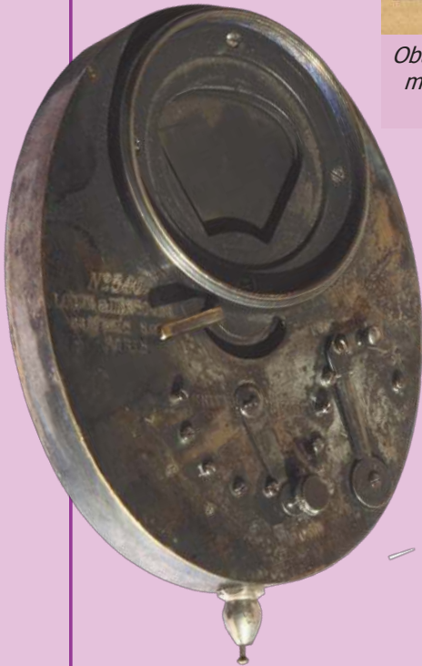
Obturateur Londe et Dessoudeix modèle C - 1889. Entièrement métallique, finition métal argenté. Obturateur présenté, numéro de série 3 402.
