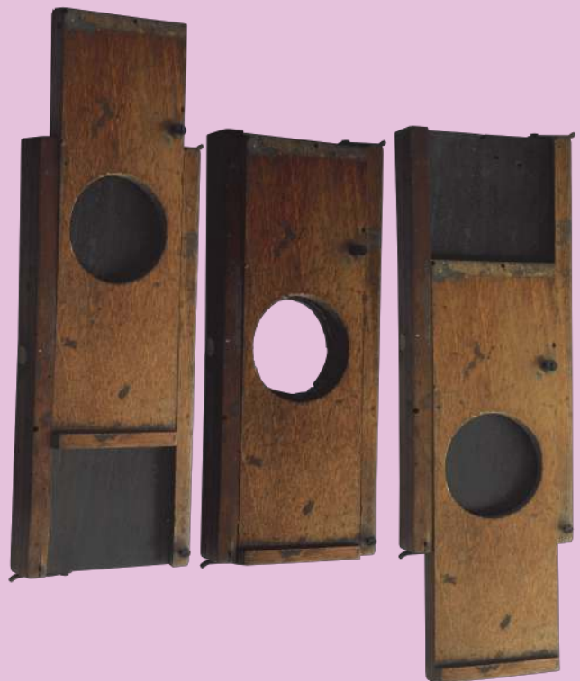
Obturateur à guillotine : De fabrication artisanale, il se place devant l'objectif. Un élastique tendu entre les deux vis sert de ressort de rappel. C'est simple, la vitesse du mouvement dépend de la force de l'élastique et du frottement dans la glissière.
