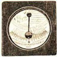
Le clisimètre du Colonel GOULIER est un petit appareil permettant de mesurer les pentes et entre autres l'inclinaison du fût des canons dans l'Artillerie.
