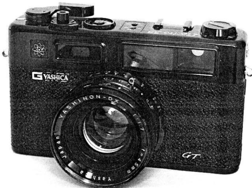
La deuxième génération d'ELECTRO 35 G est essentiellement différente par l'adoption d'un bouton de rembobinage qui assure également l'ouverture du dos lorsqu'on le tire vers le haut ; cela se traduit par la modification de l'embase qui désormais ne comporte plus l'évidement qui facilite la manoeuvre. C'est l'un des éléments à prendre en compte lors de l'identification.
