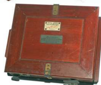
Châssis Eastman-Walker pour papier en bobines, adaptable à l'arrière de l'Express Détective (1887, 5x7")
