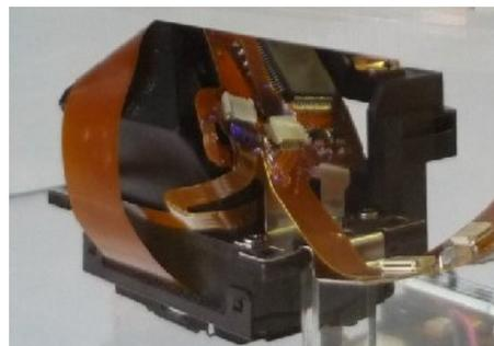
Le pentaprisme est surmonté, en particulier, par les circuits de commande des affichages du viseur (toute la place utile dans un boîtier est exploitée au mieux). La nappe de commande des affichages du verre de visée, situé juste en dessous, dont les 19 collimateurs AF, apparaît en évidence sur l'avant à gauche.
