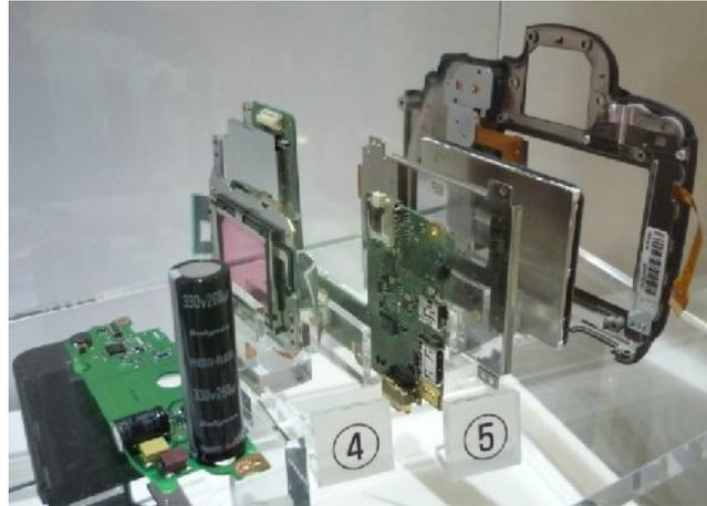
Zone 4 : capteur CMOS APS-C de 18 Mp, derrière le filtre interférentiel anti-infrarouge, réducteur de poussières par vibrations. Zone 5 : circuit imprimé portant les connecteurs (dont HDMI), mais surtout le DSP (Digital Signal Processor) Canon DIGIC 4 (top niveau), à double cœur, traitant séparément luminance et chrominance du signal image. Derrière, l'écran de visée diagonale 7,7 cm, est doublé de métal.
