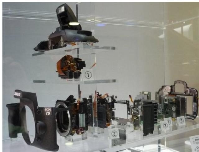
Reflex optique Canon EOS 7D qui se révèle écologique, éclaté par plans. Châssis en alliage de magnésium sans chrome, pentaprisme en verre sans plomb, comme les circuits imprimés. L'écologie mise en avant...
